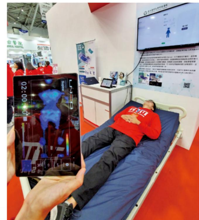
▲「智慧床墊壓力感測系統」可以24小時監測臥床病人全身的壓力指數，若病人體壓超過預設值可即時通知照護人員，讓病人免於壓瘡的威脅。
