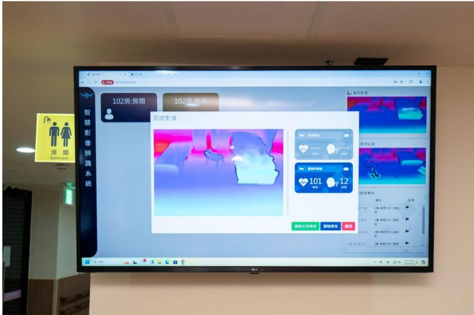
圖說：臺北市立行愛住宿長照機構採用最新型床邊照護 TOF 感測系統，利用紅外線感知元件，透過熱成像判斷住民狀態並提出警示，影像僅顯示輪廓，同時兼顧安全、隱私與降低照護人力等需求。
